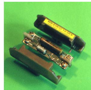
Контрольные реле напряжения и тока типа КРН и КРТ предназначены для контроля состояния устройств автоматики и телемеханики на объектах энергоснабжения. Контрольные реле могут включаться параллельно или последовательно с обмоткой контролируемого реле в случае отсутствия у последнего свободных контактов для контроля его состояния.
