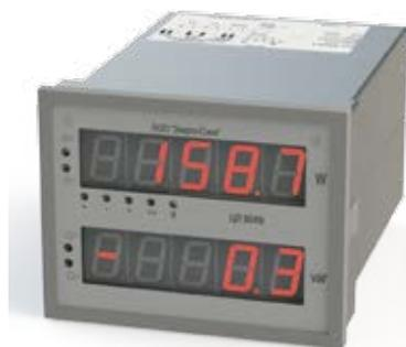
Предназначены для измерения активной и реактивной мощности переменного трехфазного тока, отображения результатов измерения на двух пятиразрядных семисегментных светодиодных отсчетных устройствах, передачи измеренных значений с использованием порта RS-485, а также для линейного преобразования в два унифицированных выходных сигнала постоянного тока. Связь с ПЭВМ осуществляется в соответствии с протоколом передачи данных MODBUS.
