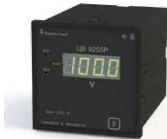
Предназначены для линейного преобразования входного сигнала в унифицированный выходной сигнал постоянного тока, отображения результатов измерения на отсчетном устройстве с учетом коэффициента трансформации первичных цепей и передачи результатов измерения на ПЭВМ с использованием порта RS-485. Связь с ПЭВМ осуществляется в соответствии с протоколом передачи данных MODBUS.
