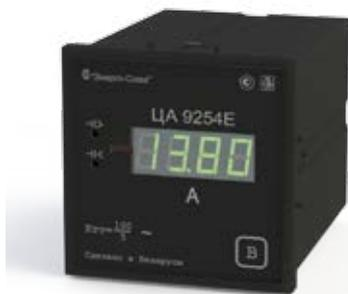
Предназначены для линейного преобразования входного сигнала в унифицированный выходной сигнал постоянного тока, отображения результатов измерения на отсчетном устройстве с учетом коэффициента трансформации первичных цепей и передачи результатов измерения на ПЭВМ с использованием порта RS-485. Связь с ПЭВМ осуществляется в соответствии с протоколом передачи данных MODBUS.
