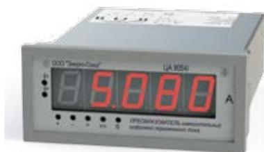
Предназначены для измерения действующего значения переменного тока, отображения результатов измерения на пятиразрядном семисегментном светодиодном отсчетном устройстве, передачи измеренных значений с использованием порта RS-485, а также для линейного преобразования в унифицированный выходной сигнал постоянного тока. Связь с ПЭВМ осуществляется в соответствии с протоколом передачи данных MODBUS.
