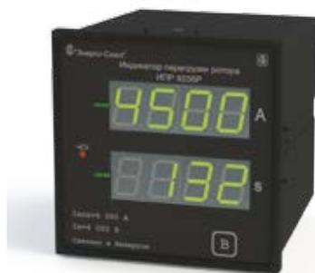
Предназначены для отображения на отсчетном устройстве величины тока ротора генератора и времени, оставшегося от момента возникновения перегрузки до момента срабатывания реле, и передачи информации по порту RS-485. Связь с ПЭВМ осуществляется в соответствии с протоколом передачи данных MODBUS.
