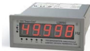
Предназначены для измерения частоты переменного тока, отображения результатов измерения на пятиразрядном семисегментном светодиодном отсчетном устройстве, передачи результатов измерения с использованием порта RS-485, а также для линейного преобразования в унифицированный выходной сигнал постоянного тока. Связь с ПЭВМ осуществляется в соответствии с протоколом передачи данных MODBUS.
