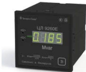
Предназначены для линейного преобразования входного сигнала в унифицированный выходной сигнал постоянного тока и отображения результатов измерения на отсчетном устройстве с учетом коэффициентов трансформации первичной цепи, и передачи результатов измерения на ПЭВМ с использованием порта RS-485. Связь с ПЭВМ осуществляется в соответствии с протоколом передачи данных MODBUS.
