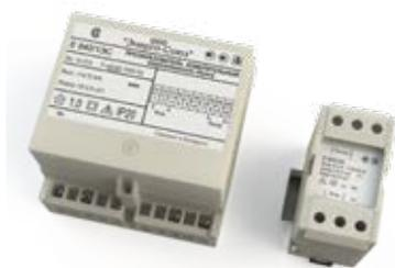
Предназначены для линейного преобразования переменного тока в унифицированный выходной сигнал постоянного тока. Преобразование производится по среднему значению входного сигнала. Выходной сигнал прямопропорционален средневыпрямленному значению входного сигнала.
