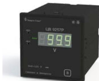
Предназначены для линейного преобразования входного сигнала в унифицированный выходной сигнал постоянного тока, измерения и отображения результатов измерения на отсчетном устройстве и передачи результатов измерения на ПЭВМ с использованием порта RS-485. Связь с ПЭВМ осуществляется в соответствии с протоколом передачи данных MODBUS.
