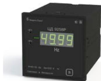
Предназначены для линейного преобразования частоты переменного тока в унифицированный выходной сигнал постоянного тока, отображения результатов измерения на отсчетном устройстве и передачи результатов измерения на ПЭВМ с использованием порта RS-485. Связь с ПЭВМ осуществляется в соответствии с протоколом передачи данных MODBUS.
