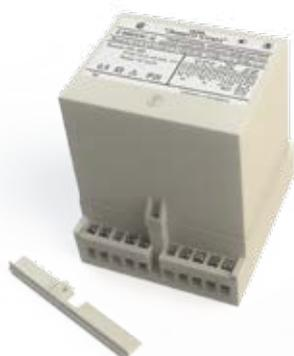
Предназначены для линейного преобразования входного сигнала активной и реактивной мощности в цифровой код, передачи результатов преобразования с использованием порта RS-485, а также для преобразования входного сигнала в 2 унифицированных выходных сигнала постоянного тока. Связь с ПЭВМ осуществляется в соответствии с протоколом передачи данных MODBUS.
