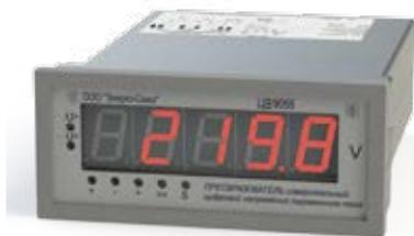
Предназначены для измерения действующего значения напряжения переменного тока, отображения результатов измерения на пятиразрядном семисегментном светодиодном отсчетном устройстве, передачи измеренных значений с использованием порта RS-485, а также для линейного преобразования в унифицированный выходной сигнал постоянного тока. Связь с ПЭВМ осуществляется в соответствии с протоколом передачи данных MODBUS.
