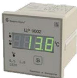
Предназначены в комплекте с термодатчиком для дистанционного непрерывного измерения температуры и отображения ее значения на отсчетном устройстве, передачи результатов измерения с использованием порта RS-485, а также для преобразования измеренного значения температуры в унифицированный электрический сигнал постоянного тока. Связь с ПЭВМ осуществляется в соответствии с протоколом передачи данных MODBUS.
