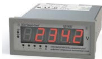
Предназначены для измерения действующего значения напряжения постоянного тока, отображения результатов измерения на пятиразрядном семисегментном светодиодном отсчетном устройстве, передачи результатов измерения с использованием порта RS-485, а также для линейного преобразования в унифицированный выходной сигнал постоянного тока. Связь с ПЭВМ осуществляется в соответствии с протоколом передачи данных MODBUS.
