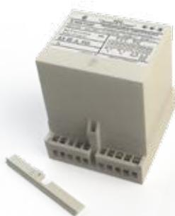
Предназначены для линейного преобразования активной и реактивной мощности трехфазных трехпроводных цепей переменного тока в два гальванически развязанных между собой унифицированных выходных сигнала постоянного тока.
