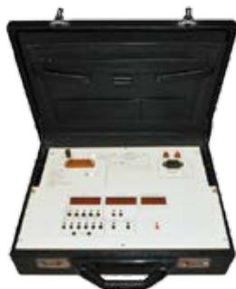
Предназначена для поверки измерительных преобразователей напряжения переменного тока, имеющих пределы основной приведенной погрешности  $\pm 0.5\%$  и менее точных, цифровых и аналоговых вольтметров с диапазоном измерения от 0 до 500 В, имеющих пределы основной приведенной погрешности  $\pm 1.0\%$  и менее точных, непосредственно на местах их эксплуатации или в условиях стационарных поверочных лабораторий.
