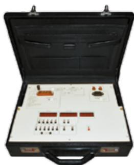
Предназначена для поверки измерительных преобразователей переменного тока с диапазоном изменения выходного сигнала от 0 до 5 мА или от 4 до 20 мА, имеющих пределы основной приведенной погрешности ±0.5 % и менее точных, цифровых и аналоговых амперметров с диапазоном измерения от 0 до 5.0 А, имеющих пределы основной приведенной погрешности ±1.0 % и менее точных, непосредственно на местах их эксплуатации или в условиях стационарных поверочных лабораторий.
