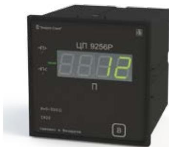
Предназначен для преобразования сигнала датчиков переключающих устройств трансформаторов под нагрузкой в цифровой код, отображения номера положения переключателя на отсчетном устройстве с последующим преобразованием в унифицированный выходной аналоговый сигнал, передачи результатов преобразования на ПЭВМ с использованием порта RS-485. Связь с ПЭВМ осуществляется в соответствии с протоколом передачи данных MODBUS.
