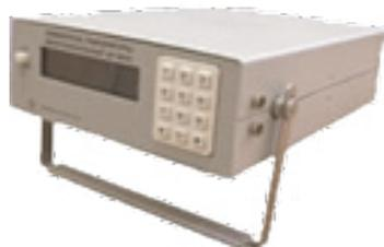
Предназначен для аттестации камер тепла-холода, сушильных шкафов, камер стерилизации или в качестве многоканального термометра с запоминанием результатов измерений и передачи результатов измерения на ПЭВМ с использованием порта RS-232. После соответствующей тарировки ЦР 9003 может использоваться как четырехканальный психрометр.
