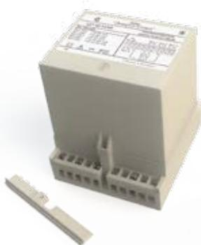
Блок аналоговых выходов ЦП 9010АВ предназначен для преобразования цифрового двоичного кода, получаемого от ЦП 9010 или ЦП 9010У по интерфейсу RS-485, в независимые гальванически развязанные аналоговые сигналы. Связь с ЦП 9010 или ЦП 9010У осуществляется в соответствии с протоколом передачи данных «Энерго-Союз».
