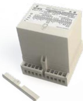
Предназначены для преобразования параметров электрических трехфазных трехпроводных или четырехпроводных цепей переменного тока частотой 50 Гц в цифровой код и передачи его по двум портам RS-485. Связь с ПЭВМ осуществляется в соответствии с протоколом передачи данных MODBUS RTU. Связь с пассивными внешними устройствами осуществляется в соответствии с протоколом передачи данных «Энерго-Союз».
