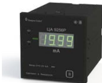
Предназначены для линейного преобразования входного сигнала в унифицированный выходной сигнал постоянного тока, отображения результатов измерения на отсчетном устройстве с учетом коэффициента преобразования первичных цепей и передачи результатов измерения на ПЭВМ с использованием порта RS-485. Связь с ПЭВМ осуществляется в соответствии с протоколом передачи данных MODBUS.
