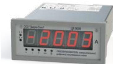
Предназначены для измерения действующего значения постоянного тока, отображения результатов измерения на пятиразрядном семисегментном светодиодном отсчетном устройстве, передачи результатов измерения с использованием порта RS-485, а также для линейного преобразования в унифицированный выходной сигнал постоянного тока. Связь с ПЭВМ осуществляется в соответствии с протоколом передачи данных MODBUS.
