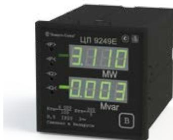
Предназначены для линейного преобразования входного сигнала в два унифицированных выходных сигнала постоянного тока, измерения и отображения результатов измерения на отсчетных устройствах с учетом коэффициентов трансформации первичных цепей и передачи результатов измерения на ПЭВМ с использованием порта RS-485. Связь с ПЭВМ осуществляется в соответствии с протоколом передачи данных MODBUS.
