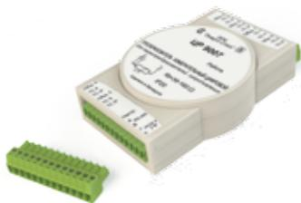
Предназначен для преобразования сопротивления термопреобразователей сопротивления по ГОСТ 6651-94 в цифровой код и передачи этого кода через порт RS-485. Связь с ПЭВМ осуществляется в соответствии с протоколом передачи данных MODBUS. Функциональный аналог: ADAM-4015.
