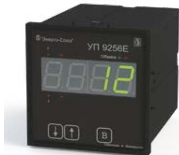
Предназначен для преобразования сигнала датчика положения привода РПН трансформатора в цифровой код, отображения номера положения переключателя на отсчетном устройстве с последующим преобразованием в унифицированный выходной аналоговый сигнал, передачи результатов преобразования на ПЭВМ с использованием порта RS-485. Связь с ПЭВМ осуществляется в соответствии с протоколом передачи данных MODBUS.
